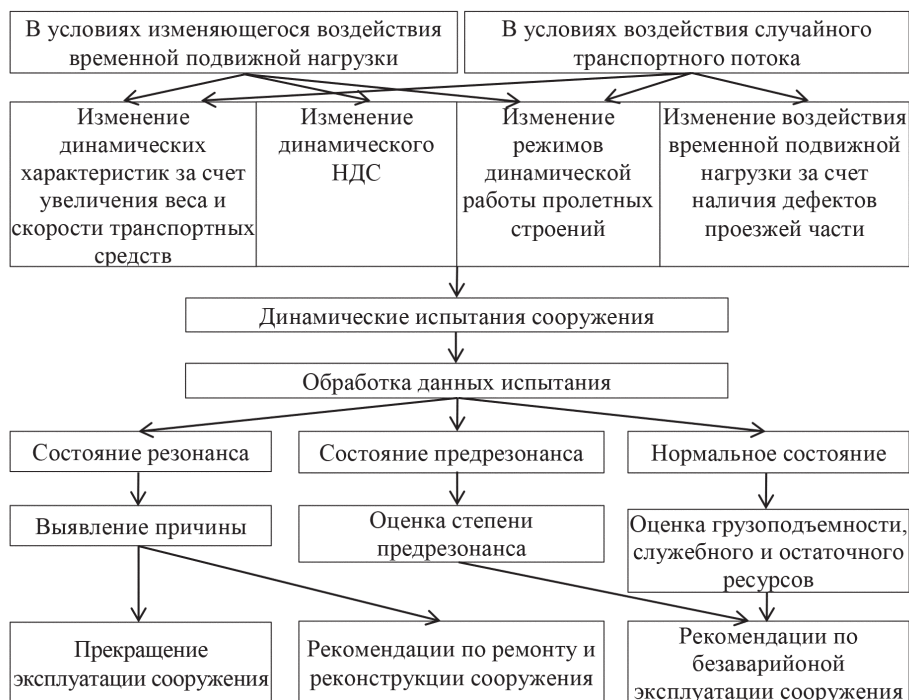
Рис. 2. Модернизированная блок-схема оптимизации вибродиагностики мостов
